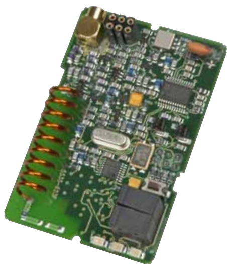
RadioRouter modul, art.nr. 6850-022-3xx (till vänster), och påbyggnadskort med status-/pulsingång och lasturkopplingsrelä, art.nr. 6850-029 (till höger).
